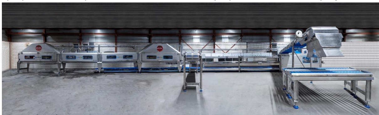
Turn Key machinelijn voor het verwerken van hydroponic geteelde gewassen
